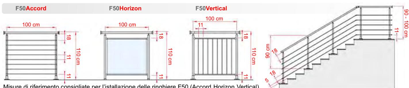
Misure di riferimento consigliate per l'installazione delle ringhiere F50 (Accord Horizon Vertical)
