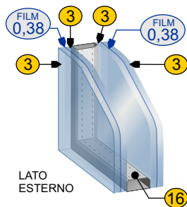
Vetro antinfortunistico (33.1/ 16 gas argon /33.1) selettivo con canalino warm edge
